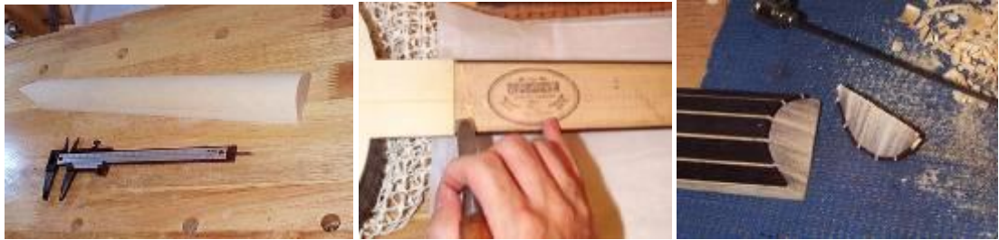
Resim 2.9: Lavta masif taşıyıcı (kayın) kısmı, klavye kısmı, sap sırtı
