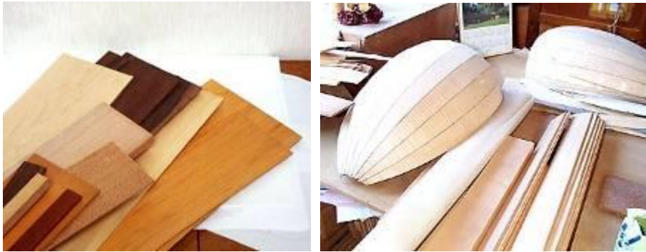
Resim 2.4: Lavta yapımında kullanılmak üzere birbirine uyumlu seçilmiş ağaçlar
