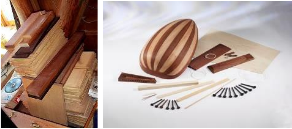
Resim 2.3: Doğal yöntemle kurutulmuş, lavta yapımında kullanılacak ağaçlar
