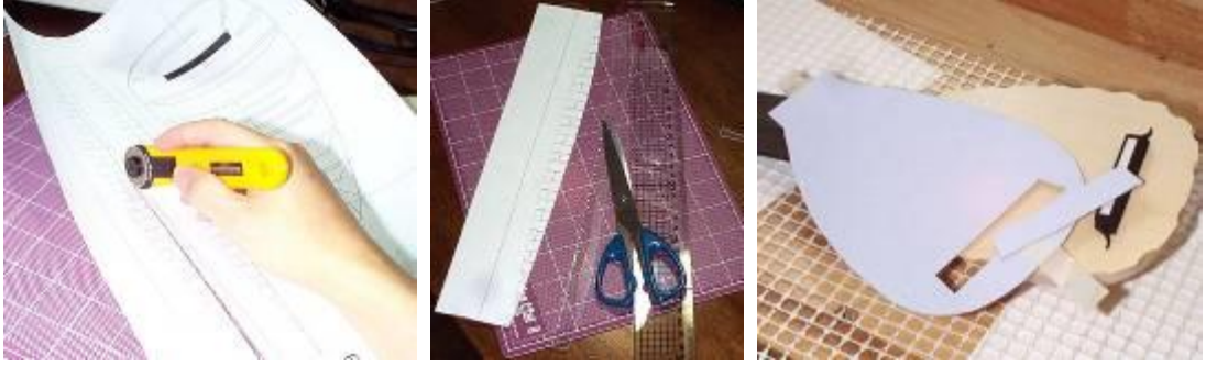
Resim 1.6: Kartona çizilmiş şablonların maket bıçağı veya makasla kesilmesi
