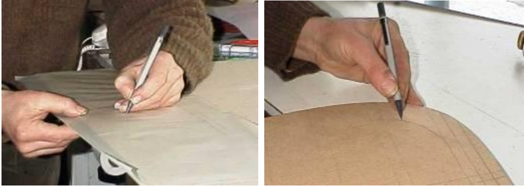
Resim 1.7: Lavta formunun karbon kâğıdıyla şablon malzemesine aktarılması
