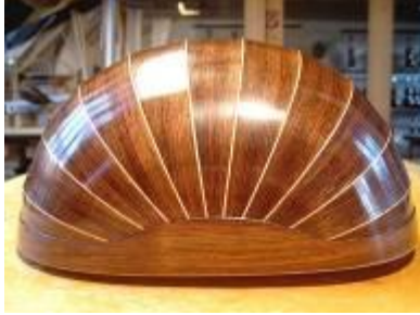
Resim 2.16: Teknede uygulanan aynalar (pelesenk ve ladin)
