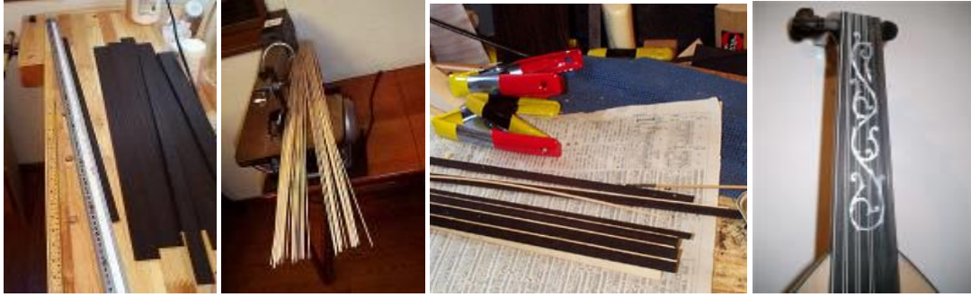
Resim 2.10: Klavye kısmı (abanoz), ladin ve abanoz sap sırtı parçaları, sedef klavye
