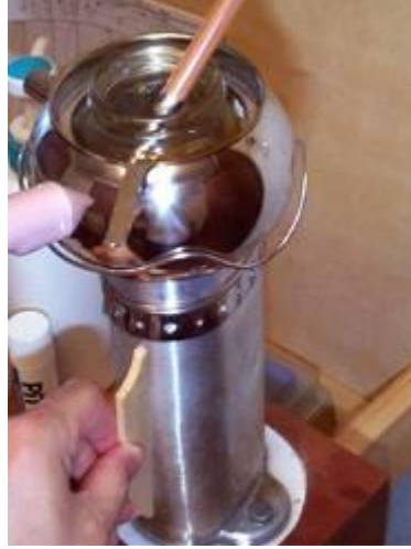
Resim 2.22: Hazırlanan tutkalın ısıtıcı üzerinde bekletilmesi
